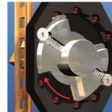
Durch Drehen des Griffs Secustic® um 180 Grad von der geschlossenen in die gekippte Position rastet der Selbstverriegelungsmechanismus in verschiedenen Positionen hrbar mit einem przisen Klick ein. Dieser typische Secustic®-Klang sorgt fr einen hrbaren Sicherheitsakzent.
